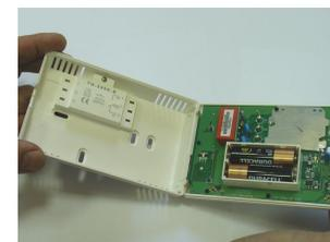
5.4. Отвинтите отверткой винт на нижней половине корпуса и снимите пластмассовую накладку.
